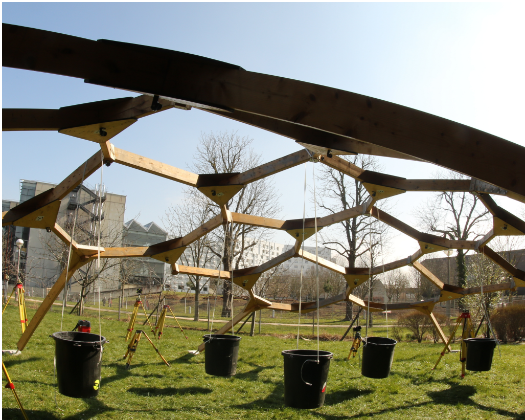
Figure 2: Poubelles pour le chargement de la structure
