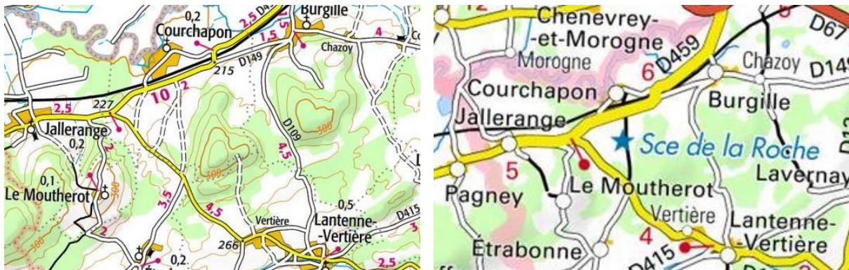
Figure 24 - Incohérence entre l'échelle 1 : 100.000 (gauche) et 1 : 200.000 (droite) pour la présence de la source
