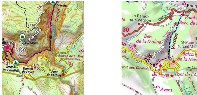
Figure 27 - Incohérence entre l'échelle 1 : 100.000 (gauche) et 1 : 200.000 (droite) pour la présence des points de vue
