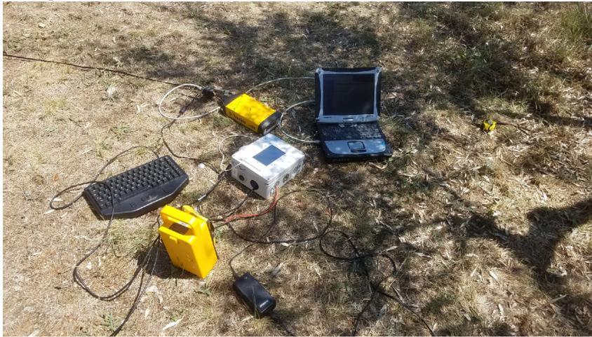
fig.15 Le récepteur low-cost, l'ordinateur de terrain et le boîtier Trimble NetR5
