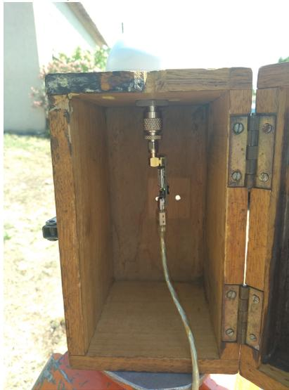
fig.9 Ce boîtier permet de fixer sur le trépied notre ensemble puce GNSS/antenne réceptrice
