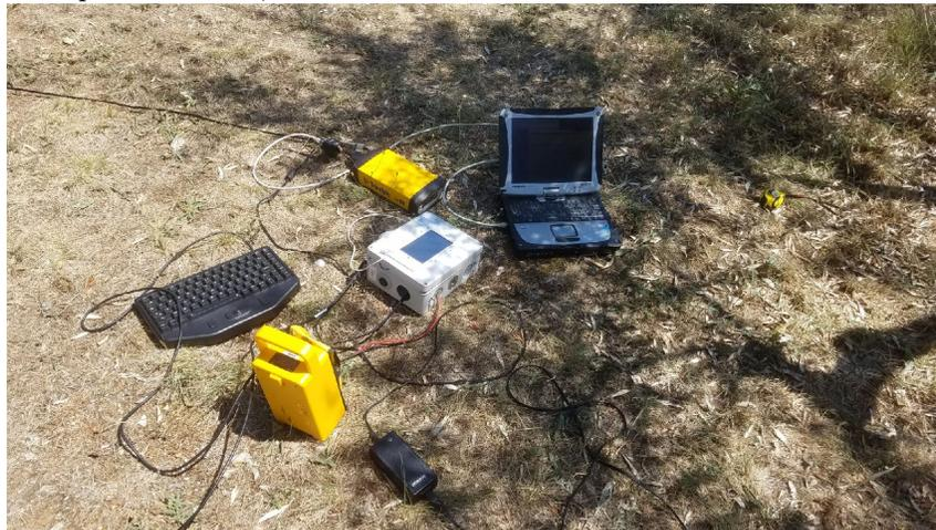
fig.14 Le récepteur low-cost, l'ordinateur de terrain et le boîtier Trimble NetR5
