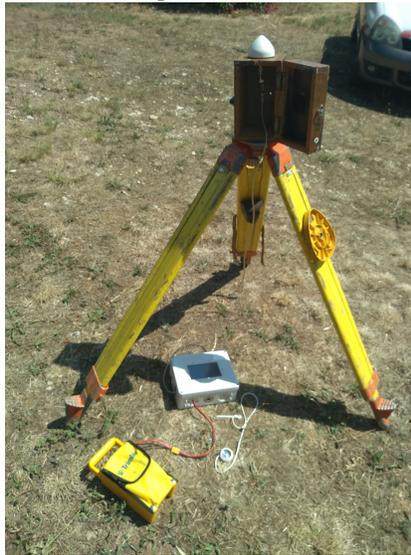
fig.8 Le test avec l'ensemble puce/antenne séparé du boîtier contenant le Raspberry Pi
