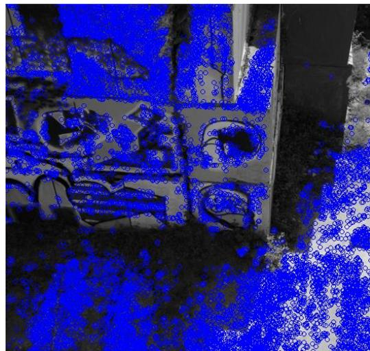
Il est à noter que les passages ombragés peuvent entraîner des erreurs au niveau géométrique. Sur l'exemple ci-après la détermination des sommets de prises de vues et des matrices rotation semble erronée.
