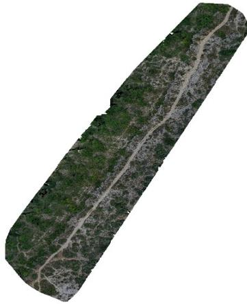
Exemple d'orthomosaïque obtenue à partir d'images drone
