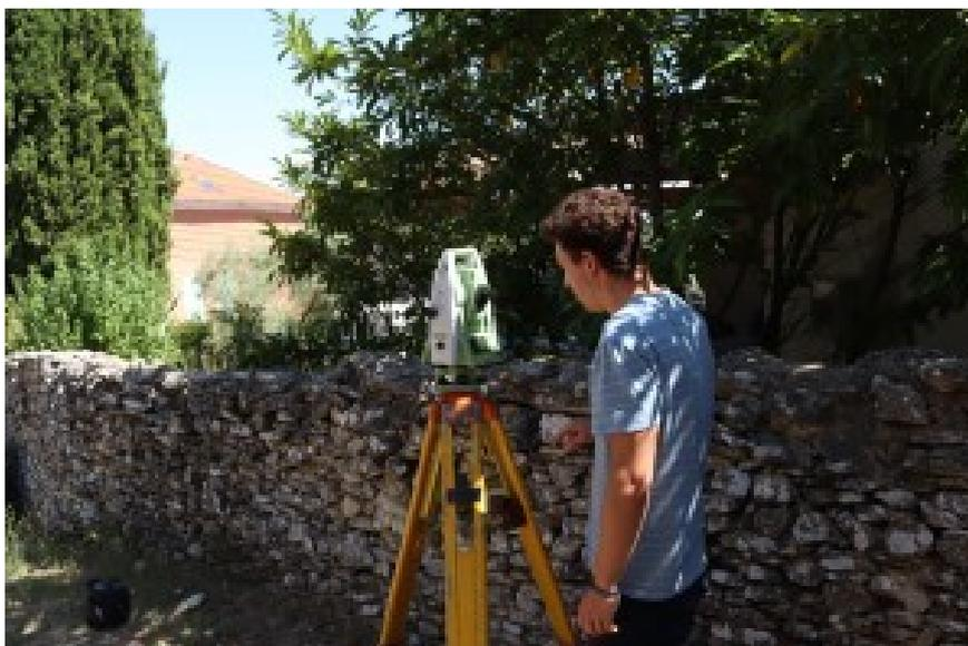
Visée au tachéomètre
