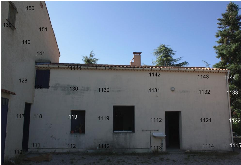
Polygone d'étalonnage du centre avec la position des cibles
