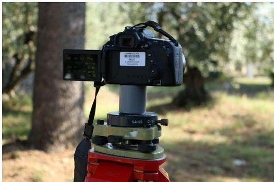
L'appareil est maintenu le plus fixement possible à l'aide d'une attache en métal vissée à l'appareil et maintenue dans une embase reposant sur un trépied. Un cylindre en plastique permet à l'appareil de reposer sur une plus grande surface afin d'éviter qu'il oscille de haut en bas. Le déclenchement de la prise de vue se fait par Wi-fi à l'aide d'une application (ici *Camera Connect Canon* car tous nos appareils étaient de cette marque) pour éviter de bouger l'appareil lors du déclenchement.
