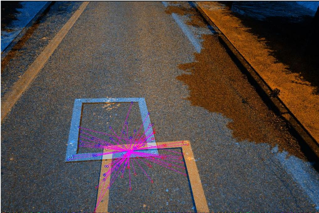
Figure 18- Mise en évidence des points de liaison sans protocole
