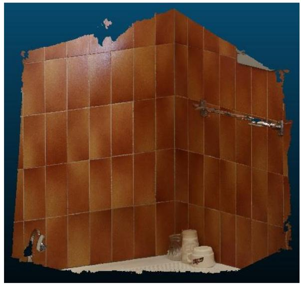
FIGURE III.48 : Modèle 3D obtenu à partir des photos retouchées : le porte-savon est supprimé
