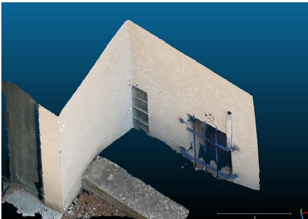
FIGURE I.7 : Résultat de la reconstruction MicMac à partir des images sur lesquelles on a ajouté le dessin des sommets du cube (ici, taches nettes 15 px au-dessus de la fenêtre)
