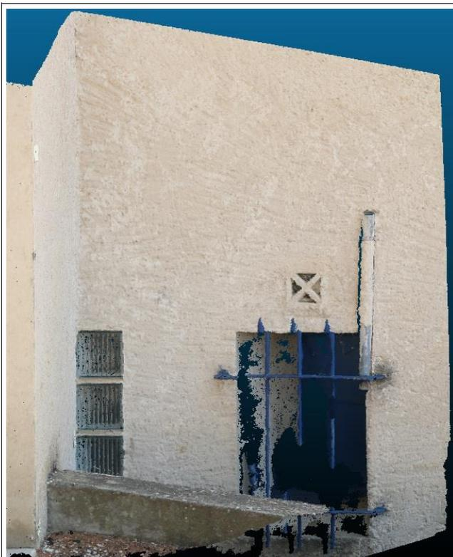
FIGURE III.38 : Modèle 3D obtenu à partir des photos non retouchées (Tests 1 à 6)
