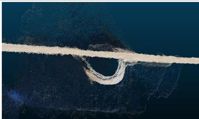
FIGURE III.18 : Détail du modèle 3D obtenu à partir des photos non retouchées : zoom sur la gouttière Vu de haut (verticale de la gouttière) (Tests 2 à 6)
