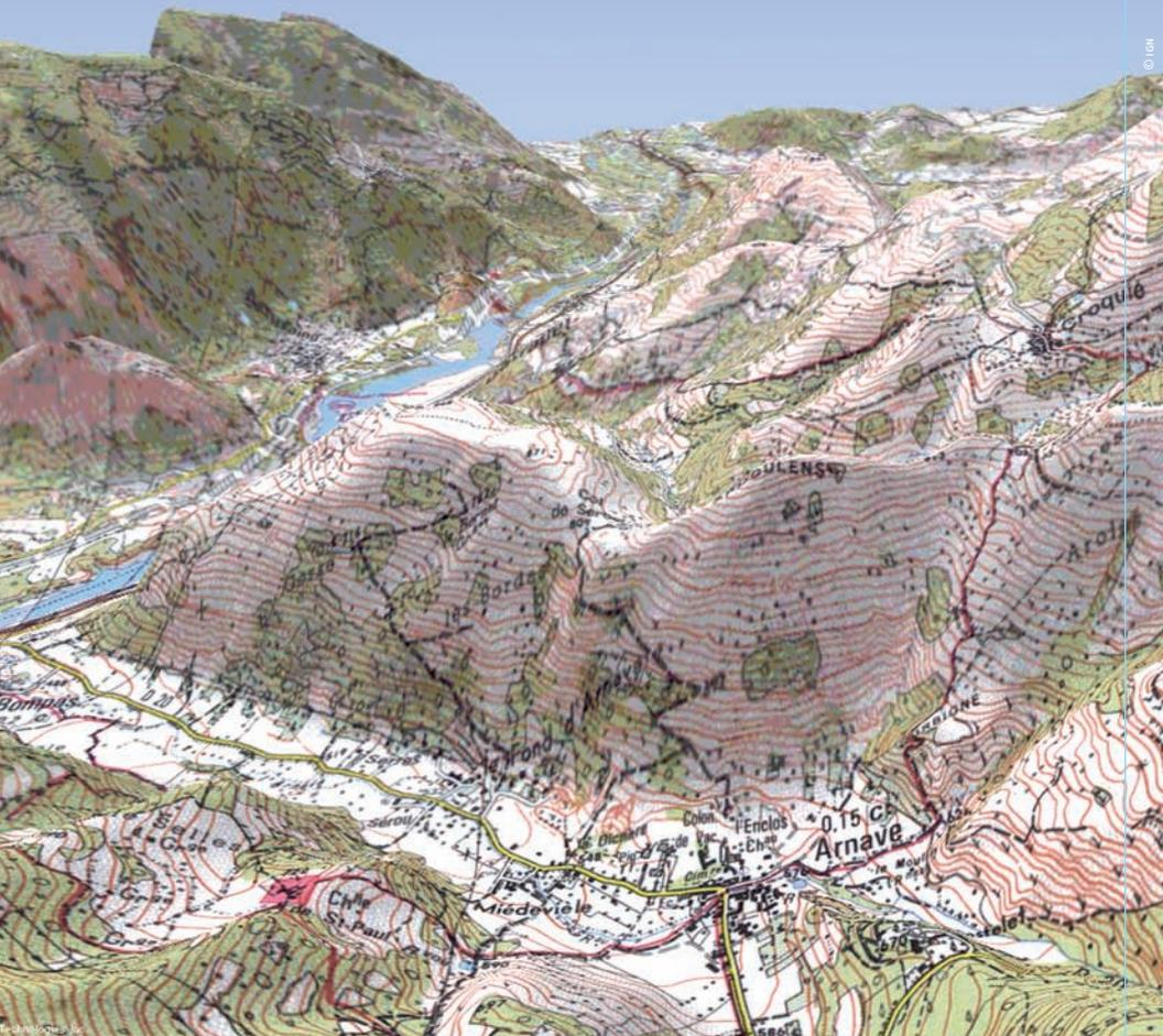
► **Vue 3D des environs d'Arnavé, dans les Pyrénées, réalisée par drapage du SCAN 25° sur un modèle numérique de terrain (MNT).**
