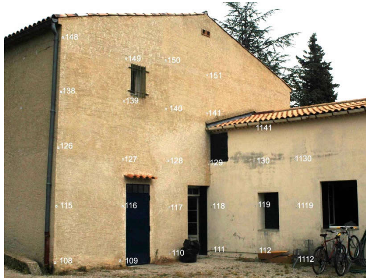
Figure 4 : Polygone de calibration des appareils photo.
